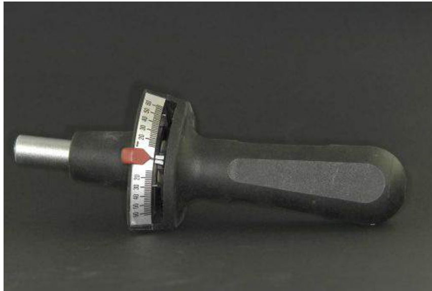
Die Abb. 6: der Schlüssel, der nach dem Drehmoment kontrolliert wird.
