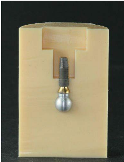
Die Abb. 14a: die Lage des Implantats in Form vom Ausguss; die Art im Schnitt.
