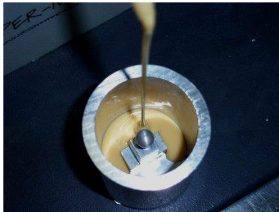
Die Abb. 11: der Ausguss des Siliziums in die Form.
